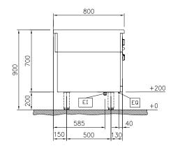
Electrical inlet (power) Equipotential screw EQ
